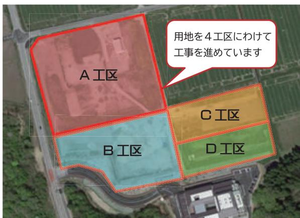
令和5年6月着工の造成工事では、工区ごとに盛土を行っております。盛土工事は、軟弱地盤対策として、造成計画高以上の余盛りを行い、地盤改良工事（プラスチックボードドレーン工法）を併用することで、地盤の沈下を進め、不同沈下を低減させています。これは、漬物をつくる際、オモシをのせ、荷重をかけることで水分を抜くことと同様の原理で、余盛り分がオモシで地盤改良工がストローの役目となり、早期に沈下促進を図り造成完了後の残留沈下や不同沈下を低減します。沈下がおさまれば余盛り分は撤去します。
