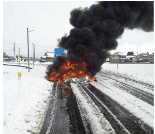
※写真は平成 25 年に発生した車両火災事故です。車両の中にはヘアスプレー缶とガスカートリッジ缶が多数混入されていました。
